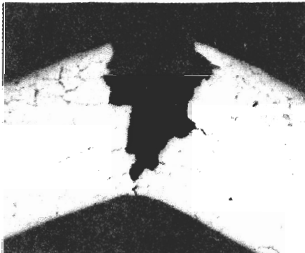
FIGURA 1-13 Cuando el hidrógeno se disuelve en cobre duro (con oxígeno residual), se produce vapor en las fronteras de grano, creando pequeños huecos. El metal entonces se torna débil, y frágil, y falla con facilidad (x50).
